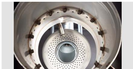
**04** Dispositif d'augmentation de la température retour intégrée
